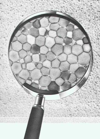
1 m³ Polystyrol-Hartschaum besteht aus rund 3-6 Milliarden mikroskopisch kleinen luftgefüllten Zellen. Darauf beruhen die hervorragende Wärme-Dämmfähigkeit und die hohe Druckfestigkeit von Polystyrol-Hartschaum. Das leichte Eigengewicht und die vielen anderen vorzüglichen Eigenschaften machen Polystyrol-Hartschaum zum idealen Isoliermaterial.
