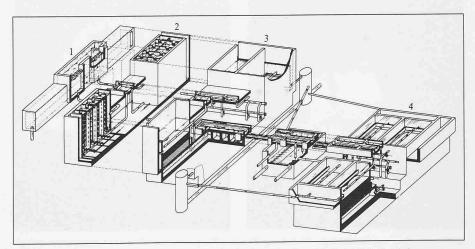
Aufbau der Wasseraufbereitungsanlage Egau (Landeswasserversorgung Stuttgart). 1: Rohwasserrinne, 2: Ozonkontaktkammern, 3: Zweischichtfilter, 4: Aktivkohlefilter
