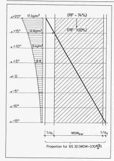
Bild 2. Temperaturverlauf durch ebene Wand
