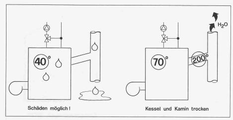
Bild 3. Wasser aus Verbrennung
