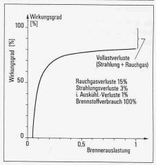
Wirkungsgrad als Funktion der Brennerauslastung
