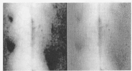
Kontrastverstärkung durch digitale Bildverarbeitung bei einer Röntgenaufnahme einer Schweissnaht
