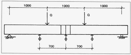
Bild 4. Biegeversuch (Schweden). Masse in mm
