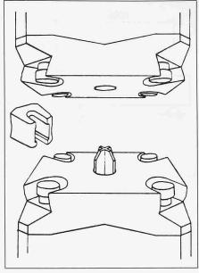
Bild 1. Obere und untere Gussplatte der Dyn-asplice-Verbindung
