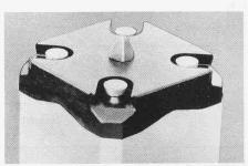
Bild 2. Untere Gussplatte auf Pfahlschuss versetzt
