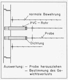
Bild 17. Überprüfung des Zustandes der Bewehrung durch Ausmessung von eingebauten Probestükken
