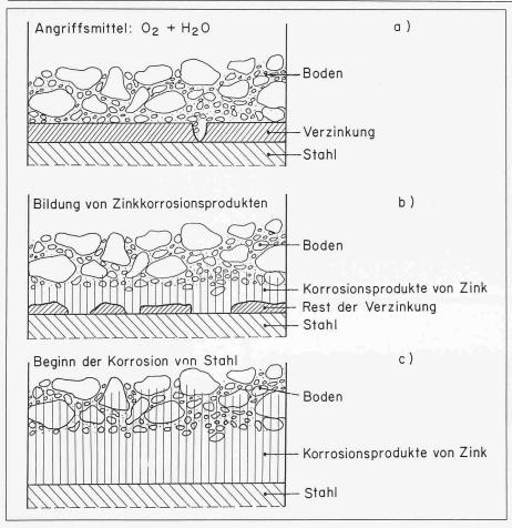
Bild 10. Angriffsmechanismus auf verzinkten Stahl im Erdboden
