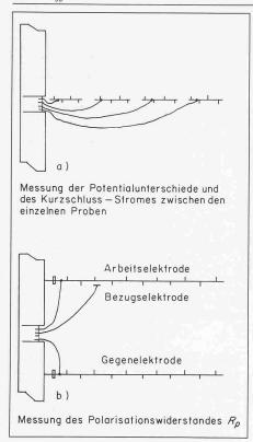
Bild 18 Kontrollmöglichkeiten der Zukunft a) Feststellung der Makroelementbildung längs eines Bewehrungseisens
