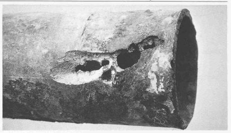
Bild 8. Blanke Angriffsstelle bei einem durch Makroelementbildung bewirkten Korrosionsangriff
