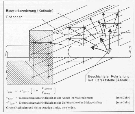
Bild 9. Einfluss des Kathoden/Anodenverhältnisses
