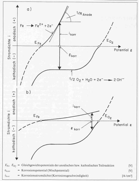
Bild 5. Stromspannungskurven und Korrosionspotential von Stahl
