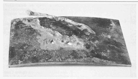
Bild 13. Korrosionsschaden an einem Öltank. Ursache: Makroelementbildung, verursacht durch einen faulenden Ast
