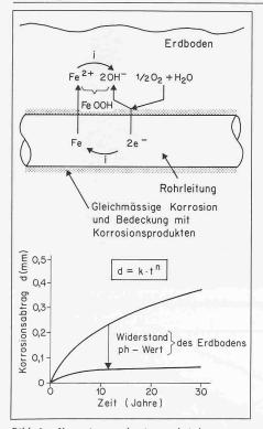
Bild 6. Korrosionsmechanismus bei homogenen Bodenverhältnissen: Mikroelementbildung
