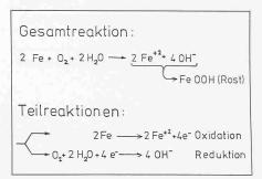
Bild 3. Reaktionsvorgänge bei der Korrosion von Stahl in neutralen, sauerstoffhaltigen Angriffsmedien
