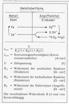
Bild 4. Korrosion als kurzgeschlossenes galvanisches Element
