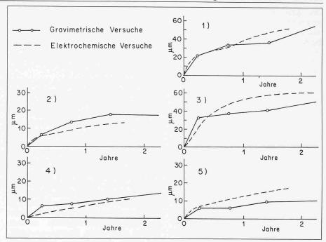
Vergleich der elektrochemisch ermittelten Werte für die Korrosionsgeschwindigkeit von verzinktem Stahl mit gravimetrisch bestimmten Daten
