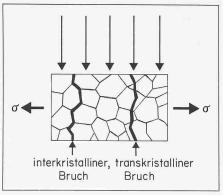
Bild 2. Erscheinungsformen der Korrosion: Risskorrosionserscheinungen bei komplexer Beanspruchung
