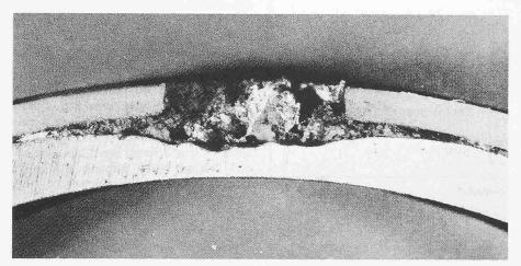
Bild 14. Korrosionsangriff, ausgelöst durch chloridhaltige Eluate aus Müllschlacke (nach [3])
