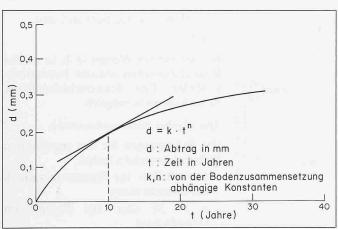
Bild 12. Korrosionsabtrag von verzinktem Stahl in Böden mit unterschiedlicher Zusammensetzung
