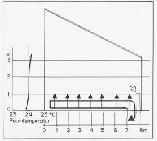
Luftverteilsystem. Temperaturverlauf (100 FLWh) in Abhängigkeit von der Raumhöhe
