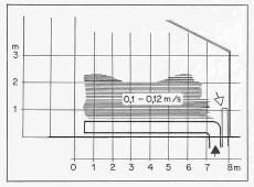
Bild 9. Luftverteilsystem. Topographie Raumluftbewegung 100 FLWh
