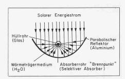
Bild 6. Parabolischer Sonnenkollektor
