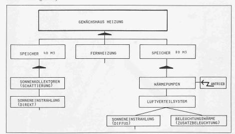
wächshaus dient, wird zusammen mit der Wärmepumpen-, Wärmespeicheranlage als bivalentes Heiz- und Kühlsystem alternativ betrieben (Bild 1).
