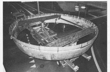
Haltering des Verschlussteils mit 9,33 m Breite und 0,35 m Höhe
