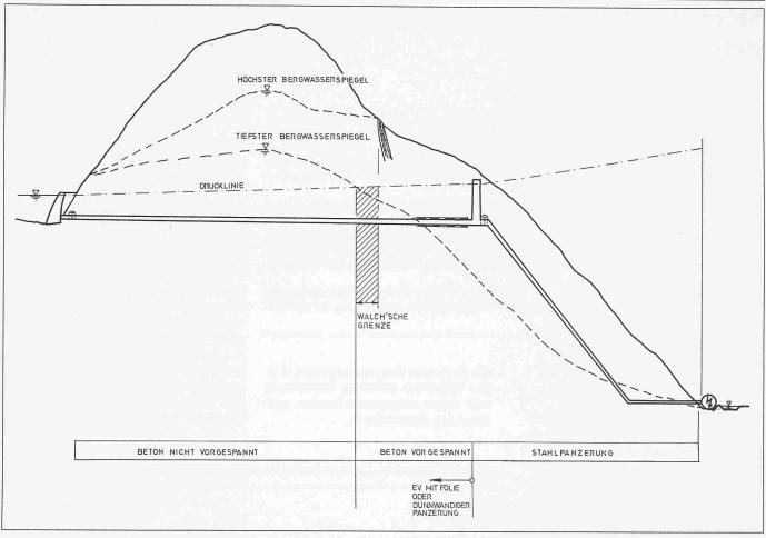
Bild. 2. Schematischer Höhenplan eines Druckstollens und Druckschachtes
