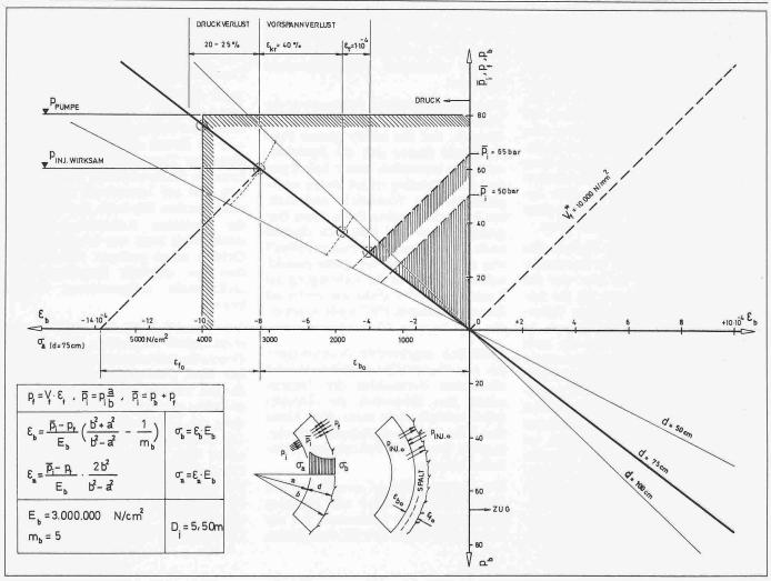
Bild 10. Bemessungsdiagramm für vorgespannte Betonauskleidungen von Druckstollen
