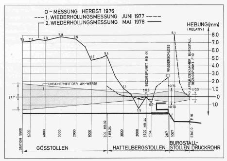
Bild 8. Nivellement im Hattelbergstollen: tektonische Hebung
