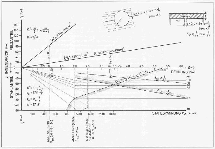
Bild 4. Bemessungsdiagramm für Druckschachtpanzerungen mit Grenzbedingungen
