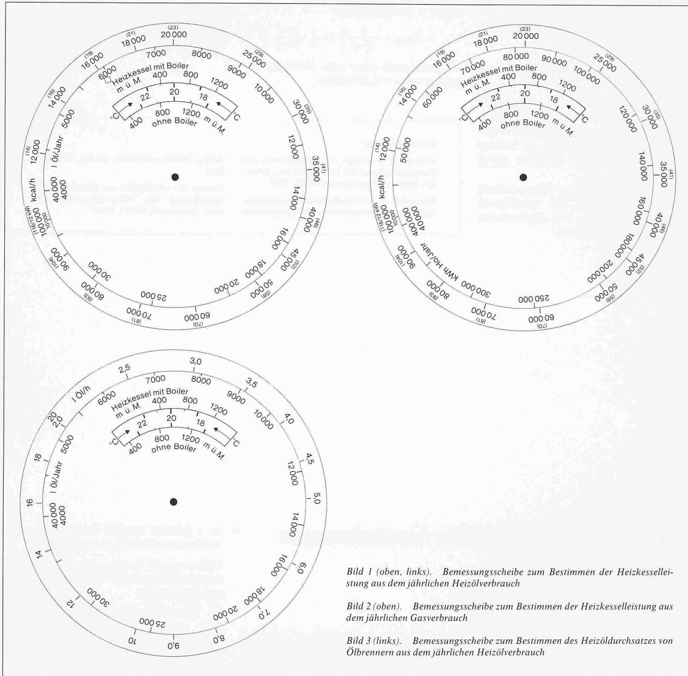
Bild 1 (oben, links). Bemessungsscheibe zum Bestimmen der Heizkesselleistung aus dem jährlichen Heizölverbrauch
