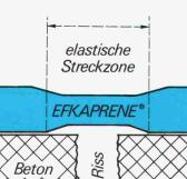
EFKAPRENE®-Brückenabdichtung überbrückt Risse und widersteht dem Tausalzwasser, der Einbauhitze von Gussasphalt und der Schubbeanspruchung
