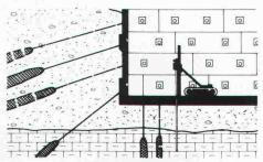
für Hang-, Fels- und Baugrubensicherung mehrfach korrosionsgeschützte Permanentanker Auftriebsanker, Tunnelverankerungen
