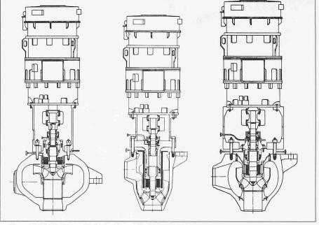
Bild 19. Drei verschiedene Typen von Hauptkühlmittelpumpen für Druckwasserreaktoren.
