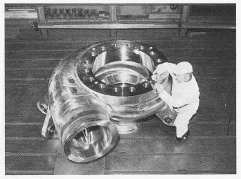
Bild 25. Hauptkühlmittel-Pumpengehäuse zu Siedwasser-Reaktor mit eingegossener Trennwand. Gewicht fertig bearbeitet 7,0 t
