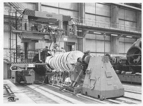
Bild 3. Automatische Schweissmaschine für Unter-Pulverschweissung (SAW). Horizontale Lage
