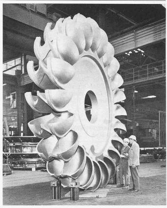
Bild 15. Peltonlaufrad «New Colgate», California. Rostfreier 13%iger Chromstahl. Gewicht 44,5 t, Durchmesser 5,4 m. Leistung pro Rad 227 000 PS (167 MW). Grösstes Peltonrad der Welt mit 22 Schauseln für 6düsige Maschine
