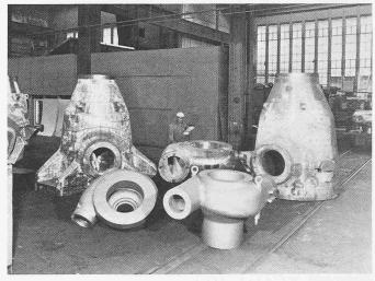
Bild 26. Hauptkühlmittel-Pumpengehäuse zu Druckwasser-Reaktoren mit grossen und kleinen Füssen sowie Pumpengehäuse zu Siedewasser-Reaktoren (Grand Gulf 1, Perry 1, Pickering)
