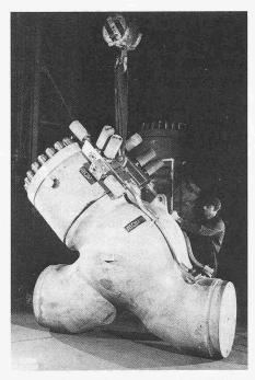
Bild 12. Eigenmediumgesteuertes Schnellschluss-Dampfisolierventil, Typ DAS 630 B, für den PWR-Reaktor Millstone III
