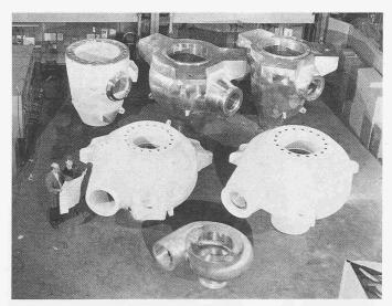
Bild 20. Reaktor-Hauptkühlmittelpumpen aller drei Typen
