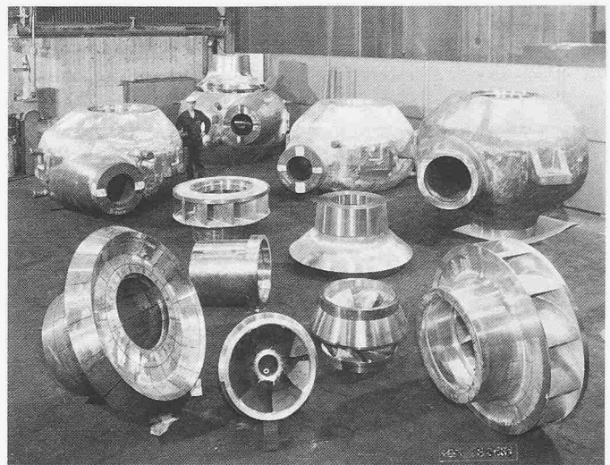
Bild 21. Hauptkühlmittel-Pumpengehäuse für Druckwasser-Reaktoren, wie sie in französischen Kernkraftwerken verwendet werden. Gehäuse, Diffusoren, Pumpenräder, Einlaufstücke, Gehäuse- und Diffusor-Adapter. Gewicht fertig bearbeitet total 34 t
