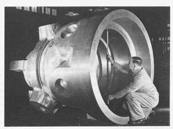
Bild 18. Topfförmiges Hochdruck-Gehäuse für Gegendruckturbine, seit 1957 in Betrieb, aus einem warmfesten 12%igen Chromstahl mit Molybdän, Vanadium und Wolfram legiert. Dampfeintritt: Druck 157/186 bar, Temperatur 600°C
