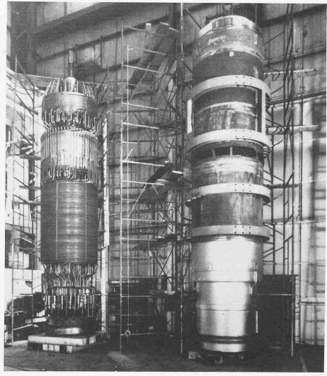
Bild 6. Links: Rohrbündel; Rechts: Dampferzeuger mit Mantel
