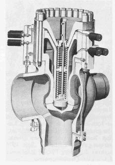
Bild 13. Querschnitt durch ein eigenmediumgesteuertes Schnellschluss-Dampfisolier-Ventil in Normalstellung (offen)
