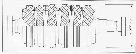
Bild 1. Schnitt und Ansicht durch einen geschweissten Turbinenrotor
