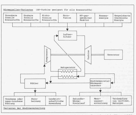
Gasturbinensysteme mit geschlossenem Kreislauf. Wärmequellen und mögliche Wärmerückfüh-Bild 30.
