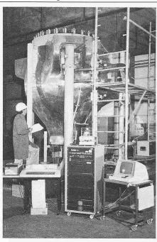
Bild 23. Hauptkühlmittel-Pumpengehäuse des 50/60-Hz-Types bei der Spannungs-Dehnungsprüfung mit aussen und innen angelegten Dehnmessstreifen. Prüfdruck 310 bar (4500 psig)
