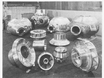
Bild 21. Hauptkühlmittel-Pumpengehäuse für Druckwasser-Reaktoren, wie sie in französischen Kernkraftwerken verwendet werden. Gehäuse, Diffusoren, Pumpenräder, Einlaufstücke, Gehäuse- und Diffusor-Adapter. Gewicht fertig bearbeitet total 34 t
