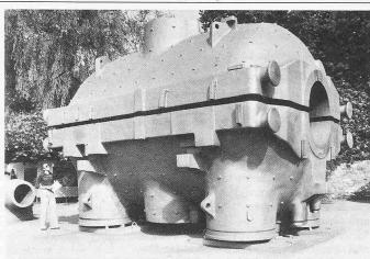
Bild 29. Hochdruck-Aussengehäuse zu einer Sattdampfturbine für eine Leistung von 1300 MWe (TVA). Korrosionsbeständiger 13%iger Chromstahl. Gewicht vorbearbeitet 180 t
