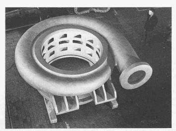
Zweistufiges Spiralgehäuse mit eingegossenen Rückflusskanälen für Pumpspeicheranlage «Lünersee», Gefälle 900 m aus unlegiertem Stahl, Gewicht roh bearbeitet 33 t
