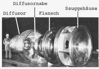
Komponenten zu einer Sekundärpumpe für einen schnellen Brüter (flüssiges Natrium), Leistung 1200 MWe. Von links: Diffusor 5,2 t, Diffusornabe 1,3 t, Flansch 1,0 t, Sauggehäuse 4,0 t. Drei solche Sätze gehören zu einer Kraftwerksausrüstung des Sekundärteiles
