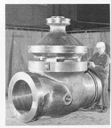
Bild 27. Schiebergehäuse mit Deckel (29 Zoll) für Primärkeislauf, Gewicht vorbearbeitet 10,0 t
