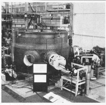
Bild 8. Neuer TIG-Plattierungsautomat für Stutzen an Reaktordruckgefässen
