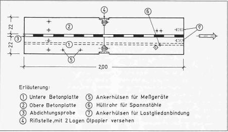
Bild 4. Schematische Darstellung des Probekörpers für die Rissüberbrückungsversuche
