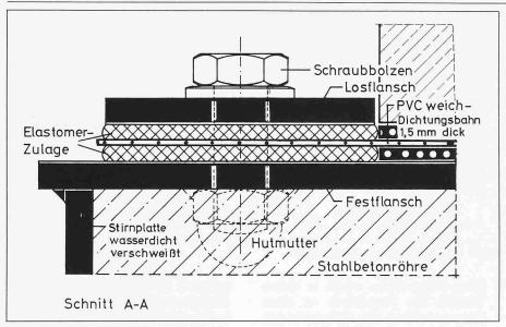
Bild 11. Flanschkonstruktion des Probekörpers
