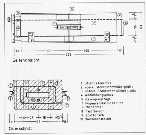
Bild 7. Schematische Darstellung des Probekörpers mit Bewegungsfuge
