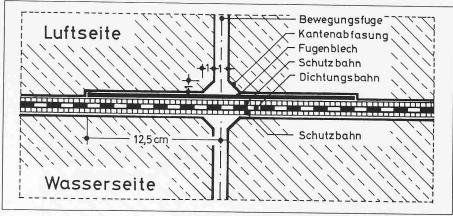
Bild 8. Querschnitt durch die Bewegungsfuge
