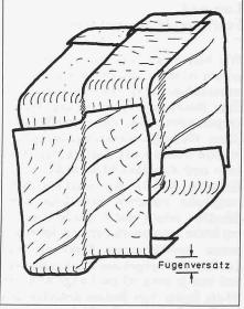
Bild 10. Durch Fugenversatz verformtes Fugen-
