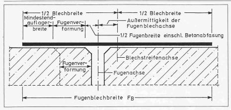
Bild 12. Schema zur Bemessung einer ausreichenden Fugenblechbreite
