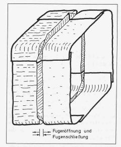
Bild 9. Verformung des Fugenblechs infolge mehrmaligen Fugenöffnens und -schliessens
