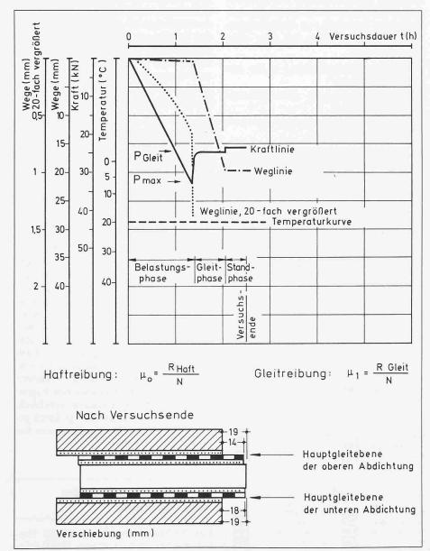
Bild 2. Versuchsablaufdiagramm am Beispiel eines Schubversuchs
