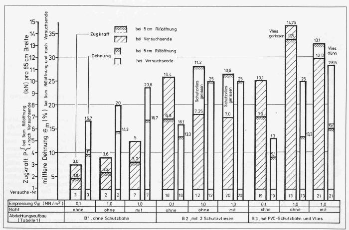
Bild 5. Vergleich von Rissüberbrückungsversuchen bei 0,1 und 1,0 MN/m² Einpressung mit und ohne Überlappnaht in der Dichtungsbahn
