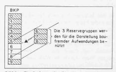
Bild 3. Eingliederung baufremder Kostenelemente im Baukostenplan
