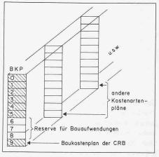
Bild 2. Neue Kostenartenpläne als Ergänzung des Baukostenplanes mit identischer Struktur
