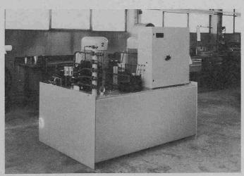
Das Hydraulikaggregat für den Antrieb der Hydraulikzylinder der Haupt- und Zwischenpressstationen mit elektrohydraulischer Steuerung, Radialkolbenpumpen und Öltank als robuste Kompaktbaueinheit
