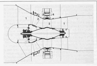
Schema der Straflo-Turbinenanlage Andenne. 1: Lagerabstützung, 2: Bewegliche Leitschaufeln, 3: Feste Laufschaufeln, 4: Generator
