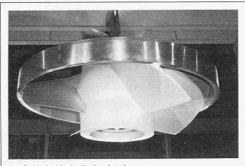
Straflo-Laufrad für das Kraftwerk Andenne
