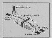
Mit dem Q-dot-Wärmetauscher lassen sich bis zu 80 % Temperaturwärme zurückgewinnen
