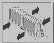
Q-dot-Wärmetauscher können durch eine einfache Kippeinrichtung leistungsgeregelt werden, zum Beispiel von Heiz- auf Kühlbetrieb oder konstante Ausblastemperatur
