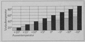
Vorlauftemperaturen bei einer Niedertemperaturheizung (Berechnungsgrundlage 55/45 °C) und einer konventionellen Radiatorenheizung bei unterschiedlichen Aussentemperaturen. Ablesebeispiel: Bei einer Aussentemperatur von -5 °C beträgt die Vorlauftemperatur bei der NTR-Heizung 45 °C, bei der konventionellen Radiatorenheizung 70 °C. Punktierte Signatur: NTR-Heizung. Schwarze Balken: Konventionelle Radiato-
