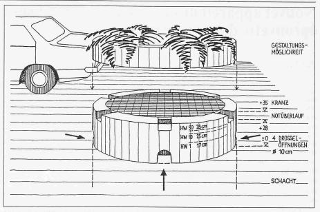
Bild 4 Beispiel für eine mögliche Ausbildung des Einlaufes zum Drosselschacht auf einer Parkfläche gemäss Bild 3
