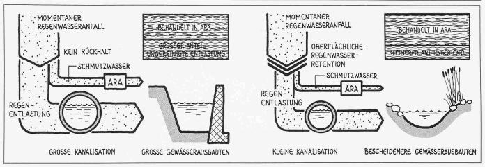
Bild 2 Prinzipielle Wirkung des Oberflächenrückhaltes auf die Abflussverhältnisse in der Kanalisation und im Vorfluter
