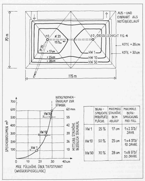
Bild 3 Anwendung des Oberflächenrückhaltes von Regenwasser am Beispiel einer 0,8 ha grossen Parkfläche mit einer Spitzendrosselung auf einen Fünftel des 10jährlichen Abflussmaximums. Die Parkfelder sind primär in der selten überstauten Zone anzuordnen
