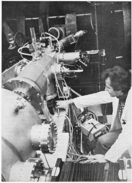
Mit einem «Gewehr» besonderer Art werden im Max-Planck-Institut für Plasmaphysik in Garching winzige Kügelchen aus tiefgefrorenem Wasserstoff in ein mehrere Millionen Grad heisses Plasma eingeschossen. Die Kügelchen erreichen dabei auf ihrer 3 Meter langen Flugstrecke die Geschwindigkeit einer Gewehrkugel. Im Hintergrund sind die Magnetfeldspulen der Fusionsmaschine Wendelstein VII-A sichtbar, die das heisse Plasma zusammenhalten
