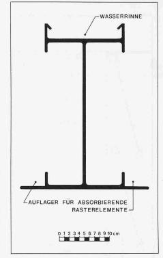
Bild 4. Tragkonstruktion. Schnitt durch Alu-Längsträger
