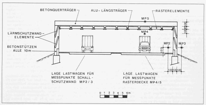
Bild 10. Rasterbauwerk Süd. Querschnitt
