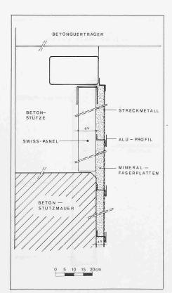
Bild 8. Rasterbauwerk Nord. Schnitt durch Lärmschutzwand
