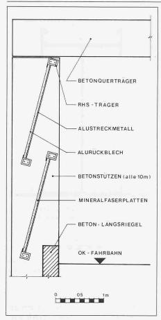
Bild 7. Rasterbauwerk Süd. Schnitt durch Lärmschutzwand
