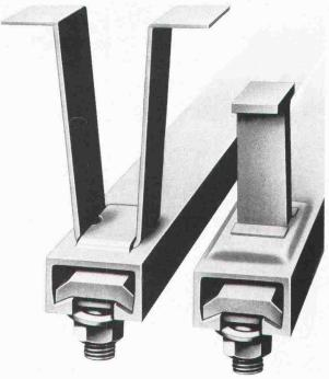
HSB-HALFENEISEN mit losen Verankerungsbügeln max. Belastung 35–120 kN/m HTA-HALFENEISEN Typ S mit Stauchankern, verlegefertig. Bauamtlich zugelassen. Max. Belastung 22–140 kN/m
