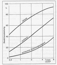
Bild 3. Reaktionsleistung in Abhängigkeit der mittleren Fahrbahnleuchtdichte und der Gleichmässigkeit (nach R. Walthert, SEV-Bulletin 65/20)
