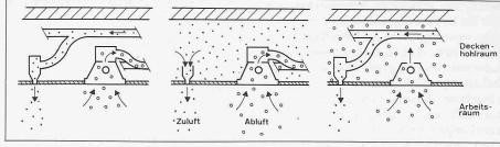
Bild 2. Drei Möglichkeiten der Abluftführung durch Leuchten
