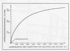
Bild 12. Bauteilcharakteristik Dach (Mehrzweck-gebäude)
