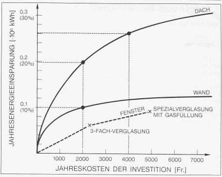
Bild 13. Bauteilcharakteristiken (Mehrzweckgebäude)
