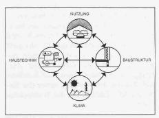
Bild 1. Thermisches Regelsystem eines Gebäudes
