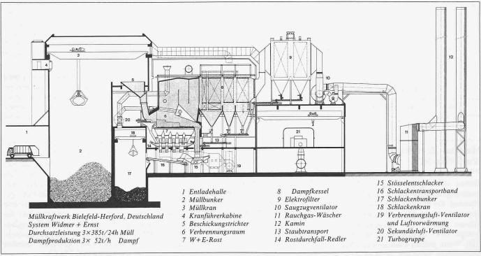
Längsschnitt eines modernen Müllkraftwerkes
