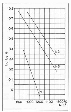
Bild 9. Die Viskosität des Glases in Funktion der Temperatur nach dem Gesetz des doppelten Logarithmus von Le Chatelier
