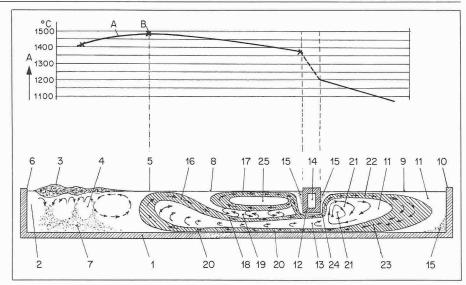
Übersicht über die hauptsächlichsten, in einer Schmelzwanne auftretenden Glasströmungen, aufgetragen über einen Schnitt durch die Längsachse.
