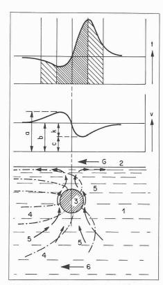
Bild 15. Verlauf der sich in einer Elektro-Glasschmelzwanne in der Nähe einer runden horizontalen Elektrode bildenden Konvektionsströmung und deren Einfluss auf die Strömungsgeschwindigkeit des Glases in Längsrichtung der Wanne.
