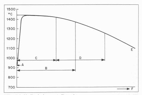
Bild 1. Verlauf des Glasschmelzprozesses im Wannenofen. A Einlegen des Gemenges, B Beheizter Teil des Wannenofens, C Schmelzen des Gemenges, D Läutern des Glasflusses, E Arbeitsende des Wannenofens, F Längsachse der Wanne
