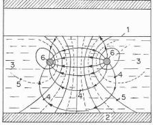
Einfluss der Randbedingungen auf den Bild 14. Verlauf der Stromlinien im Glasbad, dargestellt auf Grund von Modellversuchen am Beispiel zweier horizontaler, durch das Glasbad ganz hindurchgehender Elektroden in einem homogenen Medium bei zweidimensionaler Stromdichteverteilung.
