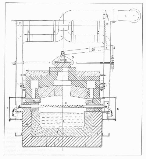
Bild 28. Schnitt durch die Kühlzone eines elektrisch beheizten Feeder-Vorherdes moderner Auführung.
