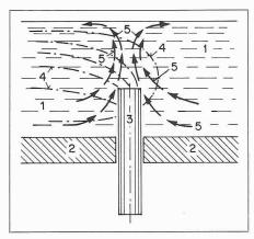
Bild 16. Oben: Konvektionsströmungen in der Wanne an senkrecht von unten durch den Wannenboden eingeführten runden Elektroden.
