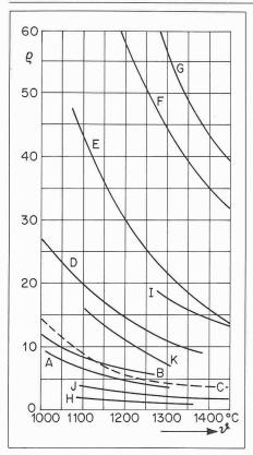
Bild 2. Spezifischer elektrischer Widerstand von Gläsern verschiedener Zusammensetzung im Temperaturgebiet des Elektro-Glasschmelzofens (nach Pevchès): vgl. hierzu die Daten der mit Buchstaben gekennzeichneten Gläser in Tabelle 4
