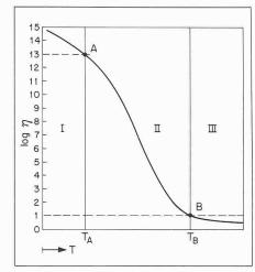
Bild 4. Die Zustandsänderungen des Glases I spröder Zustand, II viskoser Zustand, III flüssiger Zustand, A Transformationspunkt, TA Transformationstemperatur,  $T_B$  Aggregationstemperatur, B Aggregationspunkt, η Viskosität, T Temperatur
