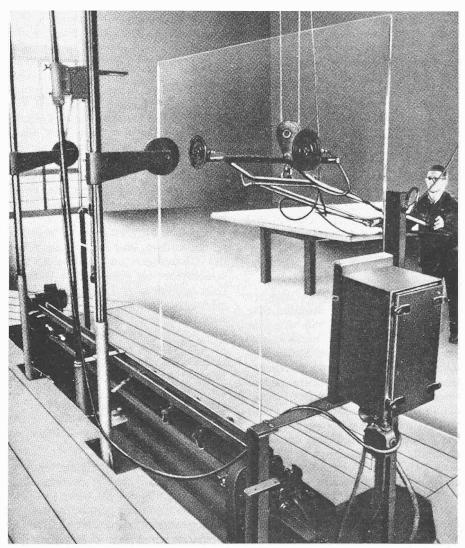
Bild 19. Flachglasherstellung nach Fourcault; Blick auf den Stand des Glasschneiders (sogenannter Abbrecherstand) mit einer Vakuum-Abbrech- und -Transporteinrichtung oberhalb des vertikalen Ziehschachtes
