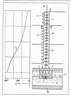
Bild 18. Temperaturverlauf im vertikalen Ziehschacht einer nach dem Fourcault-Verfahren arbeitenden Anlage für die Herstellung von Flachglas. G. Temperatur der Glastafel im Ziehschacht in °C, 1 festmontierte Walzen, 2 Anpresswalzen, 3 Kühlrohre, 4 Ziehkammer, 5 Glasspiegel in der Arbeitswanne, 6 Glasbad, 7 Ziehdüse, 8 Regulierklappen für Temperaturverteilung im Ziehschacht, 9 Stand des Glasschneiders, 10 Glastafel
