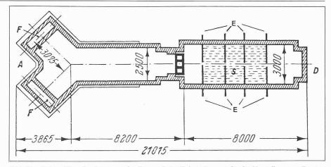
Elektro-Glasschmelzwannenofen System Saint-Gobain-Romont für die Herstellung von Fensterglas nach dem Ziehverfahren von Fourcault. D Beschickung, S eigentliche Schmelzwanne, E Elektroden, A Arbeitswanne mit Y-förmigem Ende, ausgerüstet mit zwei Fourcault-Fensterglas-Ziehmaschinen, F Ziehschächte der Fourcault-Ziehmaschinen
