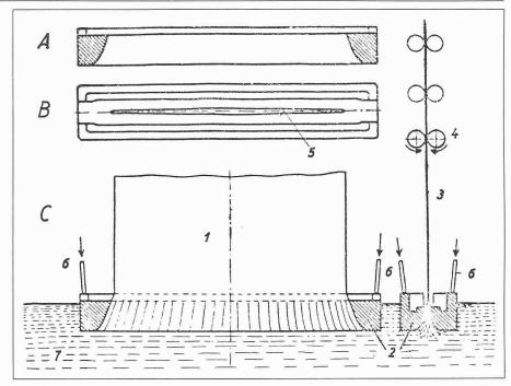
Bild 17. Arbeitsprinzip des Tafelglas-Ziehverfahrens von Fourcault.
