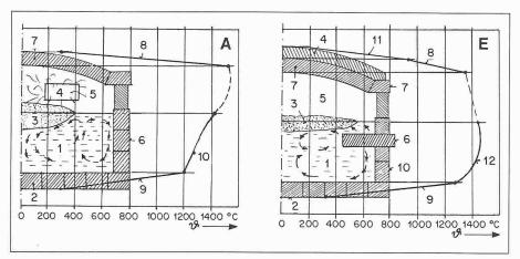
Bild 13. Temperaturverteilung in einer Schmelzwanne, aufgetragen über einen Schnitt durch die Schmelzzone. A: Ofen mit Brennstoffbeheizung. 1 Glasbad in der Schmelzwanne, 2 Wannenboden, 3 auf dem Glasspiegel schwimmendes Gemenge, 4 Brenneröffnung, 5 Gewölberaum, 6 Seitenwand der Wanne, 7 Gewölbedecke, 8 Temperaturverlauf in der Gewölbedecke, 9 Temperaturverlauf im Wannenboden, 10 Temperatur-Verteilung im Glasbad, 9 Temperatur in °C.
