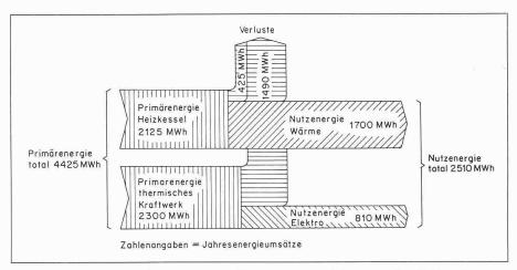
Flussdiagramm. Klassische Energieversorgung, Wärmeversorgung mit konventionellem Heizkessel
