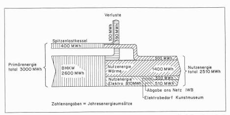
Flussdiagramm. Totalenergieanlage, Wärme- und Stromerzeugung mit Wärme-Kraft-Koppelung durch Blockheizkraftwerk
