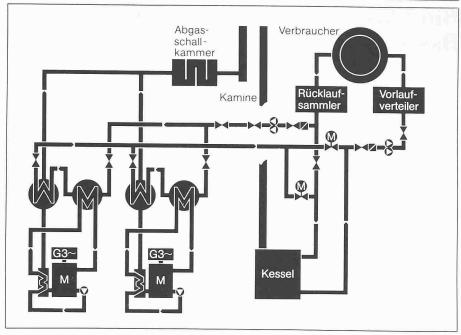
Heizwasserführung der BHKW-Anlage. Es wird die Abwärme aus Abgas, Kühlwasser und Schmieröl ge-
