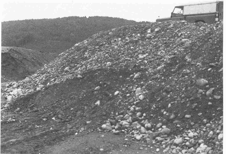
Bild 4. Hang nach Entnahme der ersten zwei Trax-Schaufeln
