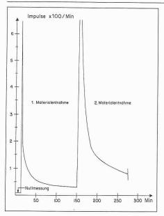
Bild 2. Micro-Seismic-Versuch, Impulszählung pro Minute
