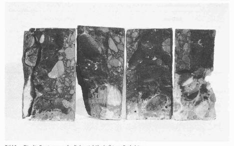
Bild 2. Für die Bestimmung der Salzsteighöhe halbierte Probekörper. Durch das Nachweisverfahren nach Collepardi et al. [5] wurde der chloridfreie Beton schwarz eingefärbt. Als Steighöhen wurden die mittleren Höhen der hellen, chloridhaltigen Flächen gemessen.
