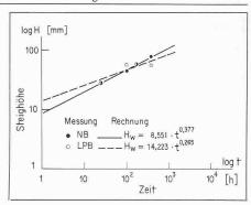
Zeitlicher Verlauf der Steighöhe von Wasser in Probekörpern, die in reines Wasser eingetaucht waren.
