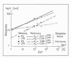
Zeitlicher Verlauf der Steighöhen von Wasser und Chloridionen in Probekörpern, die in 10%iger Kochsalzlösung eingetaucht waren.
