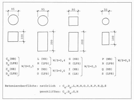
Bild 1b. Abmessungen der verwendeten Probekörper
