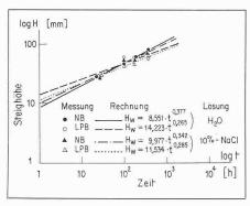
Bild 10. Einfluss des Salzgehaltes der Lösung auf den zeitlichen Verlauf der Steighöhe des Wassers in den Probekörpern.
