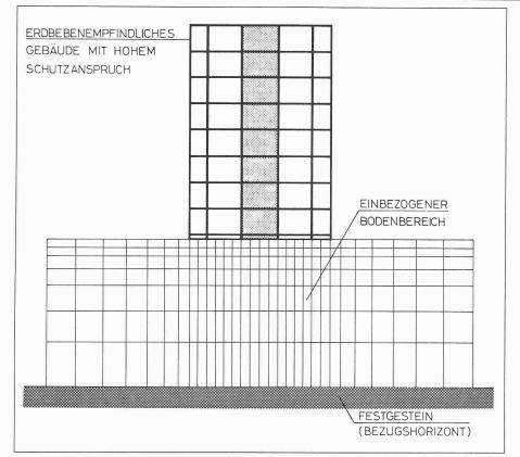
Bild 1. Schnitt durch ein komplettes dreidimensionales Bauwerkmodell mit dem mitwirkenden Baugrund
