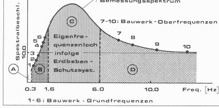
Bild 3. Übliche und angestrebte Abstimmung der Bauwerk-Eigenfrequenzen im Erdbeben-Bemessungsspektrum
