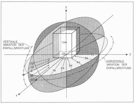
Bild 2. Ungünstigste Erdbeben-Einfallsrichtungen: Rotation der dreidimensionalen Bemessungsbeben um das Bauwerk
