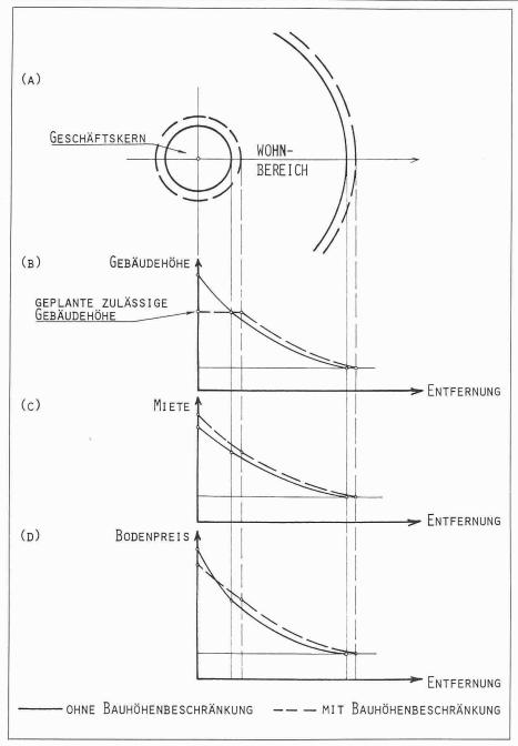
Bild 4. Schematische Darstellung der Nutzen und Kosten einer Bauhöhenbeschränkung im Geschäftskern
