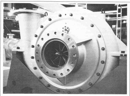
Entspannungsturbine für Freon-Kreislauf (rückgewonnene mechanische Leistung: 1,3 MW)
