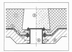
Bild 3. Grundwasserentlastungsstutzen
