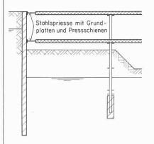
b. Grundwasserabsenkung Teilaushub Decke über 2. UG und Stahlspriesse
