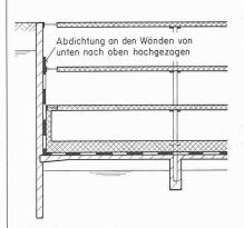
c. Grundwasserabsenkung Teilaushub Decke über 3. UG und Stahlspriesse Baugrubenaushub untere Bodenplatte horizontale Grundwasserabdichtung, schluss an die Stahlstützen mit Pressflanschen Grundwasserabdichtung an den Wänden von unten nach oben, Anschluss an die Grundplatten der Stahlspriesse mit Pressflanschen Betonieren der Bodenplatte und der Wände, Ergänzung der Geschossdecken, wobei die Stahlspriesse einbetoniert werden.
