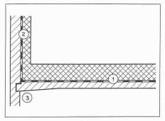
Bild 2. Setzungsfreier Übergang der Bodenplatte zur Baugrubenumschliessung
