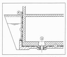
Bild 1. Offene Baugrube und Aussenabdichtung 1 Grundwasserabdichtung horizontal mit Schutz-
