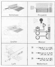
Bild 3. Schusseintragsysteme für Webmaschinen
