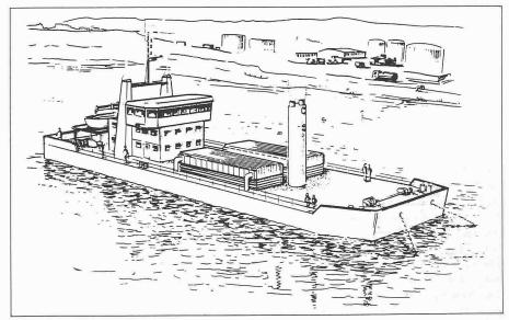
Im Frühighr 1982 wird diese schwimmende Meerwasserentsalzungsanlage nach Abu Dhabi geliefert. Die seegehende Barge mit eigenem Antrieb erzeugt für die Bevölkerung und für Baustellen an der Küste dort täglich 2500 m3 Trinkwasser
