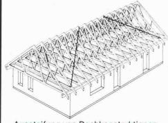
Aussteifung von Dachkonstruktionen. Windverband und Windgitterverband in Dächern aus Balkenkonstruktionen. Verankerung von Fusspfetten.
