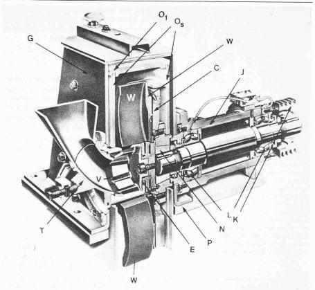
Bild 7. Schnittbild eines mit nach vorn gekrümmten Wurfschaufeln und mit mechanischer Vorbeschleunigung des Strahlmittels mittels Verteiler und Einlaufstück ausgerüsteten Schleuderrades, mit der Bezeichnung Rotoblast «Type RK CurVane». Ausführung als Ein-Scheiben-Rad.
