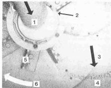
Bild 4. Ausschnitt aus einem Hochgeschwindigkeitsfilm, der mit einer Geschwindigkeit von 8000 Bildern je Sekunde und mit einer Belichtungszeit von 1/32000 Sekunden je Bild aufgenommen worden ist. Die Strahlmittel-Körner sind gut zu erkennen. Die Austrittsrichtung der Strahlmittelpakete ist durch den Pfeil 3 angegeben. Das Schleuderrad ist ebenfalls gut erkennbar, so dass der Abwurfwinkel τ zwischen Austrittsrichtung und der Radtangente im Bild ausgemessen werden kann.
