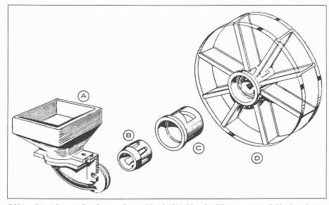
Bild 1. Die wichtigsten Bauelemente des von Minich 1934/35 in den USA patentierten Schleuderrades mit indirekter Einführung des Strahlmittels durch mechanische Vorbeschleunigung mit Hilfe von Einlaufstück und Verteiler (siehe auch Bild 2).
