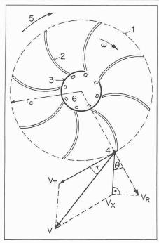
Bild 11. Geschwindigkeits-Diagramm in Vektor-Darstellung zur Berechnung der Abwurfgeschwindigkeit eines Strahlmittelkorns beim Austritt aus einem mit nach vorn gleichförmig gekrümmten, konkaven Wurfschaufeln bestückten Schleuderrad.
