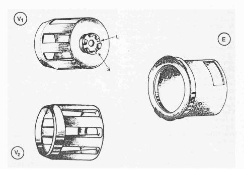
Verteiler und Einlaufstück des «CurVane Typ RK» Schleuderrades mit nach vorn gekrümmten Wurfschaufeln. Im Boden des Verteilers sind auf der Rückseite die durch Nocken gebildeten beiden Montage-Stellungen «S» und «L» gut zu sehen, wobei «S» für einen kurzen Hot Spot und «L» für einen gestreckten langen «Hot Spot» steht.
