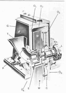
Bild 5. Schnittbild eines mit geraden, radial angeordneten Wurfschaufeln sowie mit Verteiler und Einlaufstück ausgerüsteten «Rotoblast-Schleuderrades» mit der Typenbezeichnung «RI» der Firma Pangborn Corporation Hagerstown USA aus dem Ende der sechziger Jahre.
