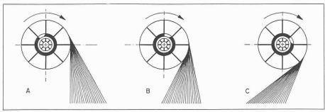
Bild 2. Einstellen des Schleuderstrahls durch Verdrehen des Einlaufstückes beim Schleuderrad mit indirekter Einführung des Strahlmittels und mechanischer Vorbeschleunigung mit Hilfe von Einlaufstück und Verteiler (vgl. auch Bild 1).
