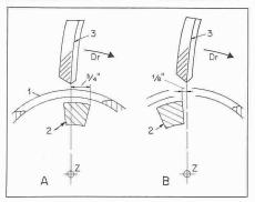
Veränderung der Länge des «Hot Spots» im Strahlbild beim mit nach vorn gekrümmten Wurfschaufeln ausgerüsteten «CurVane» Type RK Schleuderrad.
