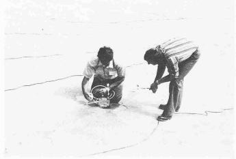
Bild 8. Prüfung eines über einer undichten Stelle aufextrudierten KDB-Stückes mit dem Vakuumprüfapparat
