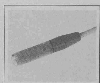
Messgeber eingeschoben und nach aussen abgedichtet. Das heraushängende Kabel wird an das Novasina Luftfeuchte-Messgerät Modell MIK angeschlossen und die Messung kann durchgeführt werden. Direkt ablesbar: Die relative Materialfeuchte in % rF.
