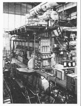
Ein Sulzer-Sechszylinder-RLA90-Motor auf dem Prüfstand in Winterthur
