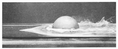
Hufeisenförmiger Wirbel um eine Halbkugel in einer Grenzschichtströmung
