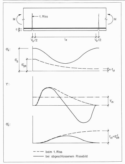
Bild 1. Schematische Darstellung der Rissbildung
