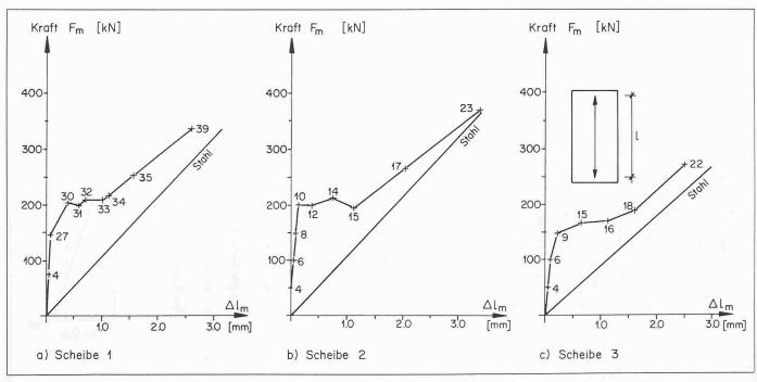
Bild 6. Last-Scheibendeformation  $\Delta I_m = mittlere \ Scheibenverlängerung \ (Ränder \ und \ Scheibenmitte \\ F_m = mittlere \ Zugkraft \ (Anfangs- \ und \ Endwert \ je \ Laststufe)$
