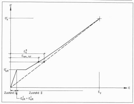
Bild 2.  $\sigma_s - \varepsilon_s - Diagramm des Verbundstabes$
