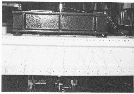
Bild 9. Rissbildung eines Trägers mit Vorspannung ohne Verbund
