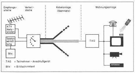
Bild 1. Prinzipskizze des neuen Breitbandkommunikationssystems mit Lichtwellenleitern in Berlin
