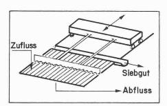
Bild 3. Mechanisch gereinigter Feinrechen. Schema (Firma Bieri, Liebefeld)
