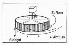
Bild 5 Zentrisieb. Schema (Firma Noerdlinger, Zürich)
