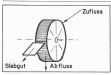
Rotostrainer. Schema (Firma Mecana, Schmerikon)
