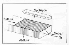
Bild 14. Statischer Feinrechen. Schema (Vorschlag EAWAG)
