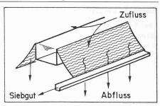
Bild 12. Hydrasieve-Anlage. Schema (Firma Picatech, Kriens)
