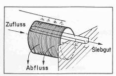
Bild 4. Regenauslasstrommel. Schema (Firma Roshard, Küsnacht)
