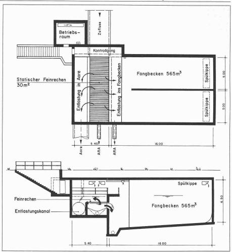
Bild 15 und 16. Gewählte Kombianlage. Grundriss und Längsschnitt
