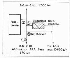
Bild 2. Regenentlastung Elfenau. Schema
