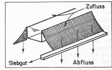
Bild 13. Hydroscreen-Anlage. Schema (Firma Mecana, Schmerikon)
