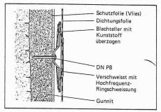
Bild 8. Südportal. Verbindung Teller-Folie. Hochfrequenz-Ringschweissung
