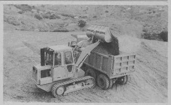
Der neue Caterpillar-Kettenlader 943. 11,2 t Einsatzgewicht, 60 kW (80 PS) Motorleistung, Kübelinhalt 11501.
