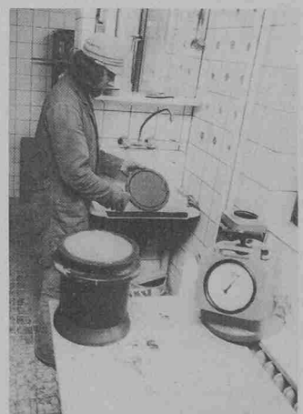
Neuer Luftgehaltsprüfer Porotest für Beton. Alle Bedienelemente, das grossflächige Manometer und eine Wasserkammer sind in den kompakten Gerätekopf eingebaut, der durch zwei Schnellverschlüsse mit dem Probenbehälter verspannt wird
