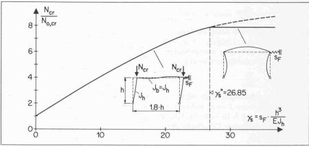
Bild 2. Verlauf der Verzweigungslast N<sub>cr</sub> des quergefederten Rahmens in Funktion des Steifigkeitswertes  $\gamma_s$ ; Definition der Mindeststeifigkeit  $\gamma_s^*$
