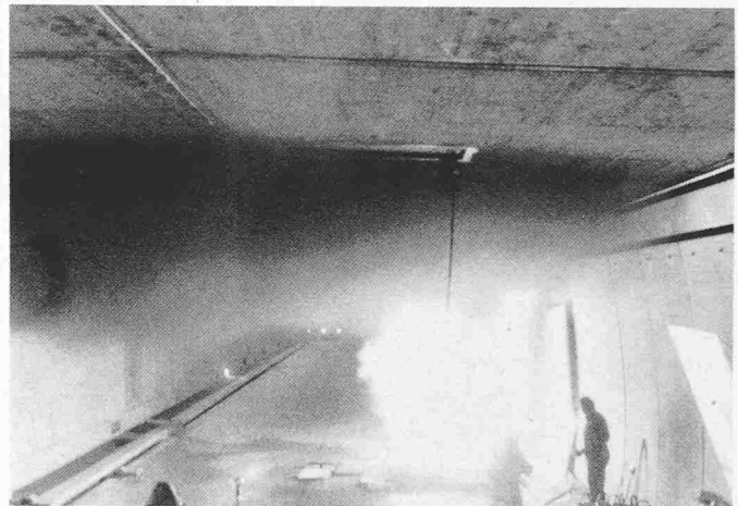
Bild 4. Seelisberg-Autobahntunnel, Brandversuche: Situation im Tunnel, 15 Sekunden nach Entzündung von 18 Litern Benzin
